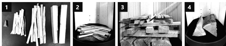
Obr. 4 Postup přípravy dřeva ve spalovací komoře
