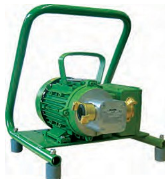
Čerpadlo UNISTAR 2000-B, max. 60 lit/min, max. 4 bary Motor 0,55 kW, 1x230V, 4 A, 50 Hz, 2800 ot/min
